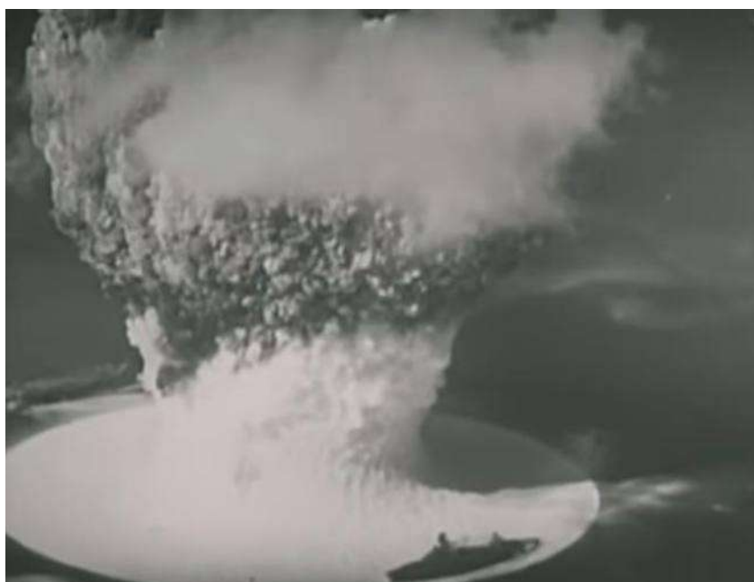
Рис. 2: Максимальный выброс воды (порядка 450 м высотой)
